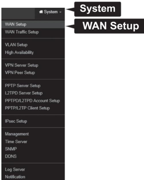
14. L'interface WAN du routeur est paramétré par défaut sur IP dynamique (appelé aussi DHCP). Pour modifier les paramètres de connexion Internet du WAN 1, cliquez sur le bouton Edit (Changer) dans la colonne de droite.
