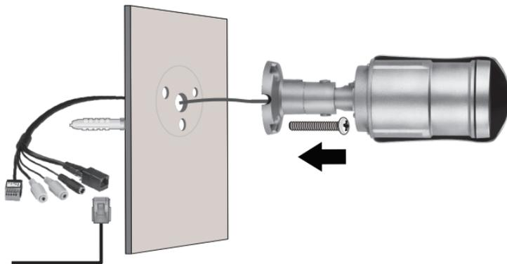
9. Mettez la caméra sous tension en connectant l'autre extrémité du câble à un switch ou un injecteur PoE de votre réseau.
