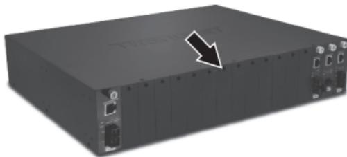
2. Lösen Sie die Schraube und nehmen Sie den Glasfaserkonverter aus dem Metallgehäuse.
