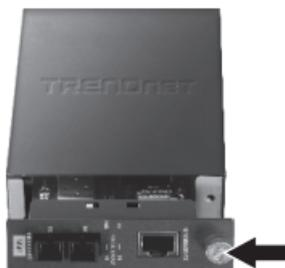
3. Schieben Sie den Glasfaser Konverter in einen freien Steckplatz und ziehen Sie die Schraube wieder an.
