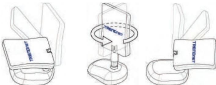
**AVERTISSEMENT:** L'antenne peut basculer de 0° à 180° et pivoter à 360°. Le câble interne de l'antenne étant fixé, veuillez ne pas faire pivoter l'antenne au-delà de 360°.
