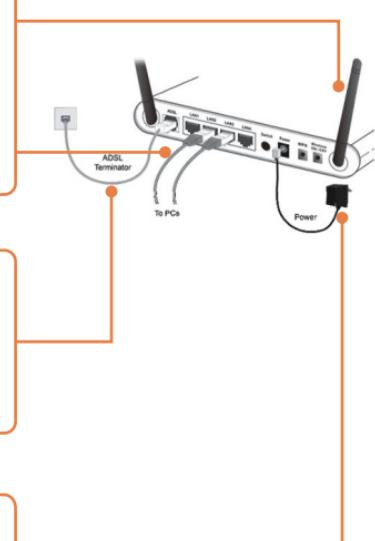
2. Conecte la punta del cable RJ-11 a uno de los puertos ADSL del TEW-635BRM. Conecte la otra punta del cable al jack telefónico.
