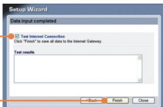
11. Vergewissern Sie sich, dass der Test erfolgreich abgeschlossen wurde. Überprüfen Sie, dass die LEDs **ADSL** und **Internet** leuchten. Klicken Sie dann auf **Close** (Schließen).
