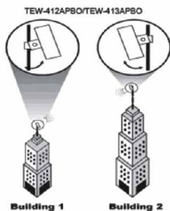
Figura 3,1: Ajustar el TEW-412APBO/TEW-413APBO para una mejor recepción
