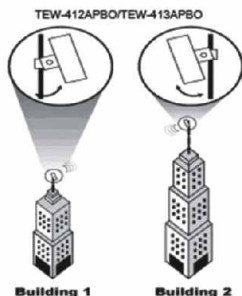
Abb. 3.1: Ausrichtung des TEW-412APBO/TEW-413APBO für den besten Empfang
