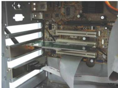
4. Schrauben Sie die Metallklammer der PCI-Karte mit einer Standardschraube im Gehäuse fest. Bringen Sie die beiliegende Antenne an der Steckverbindung am Ende Ihrer Karte an.
