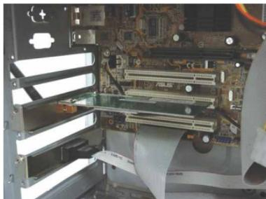
4. Vissez le support métallique de la carte PCI sur vote boîtier avec une vis standard. Fixez l'antenne fournie à la prise située à l'arrière de votre carte.
