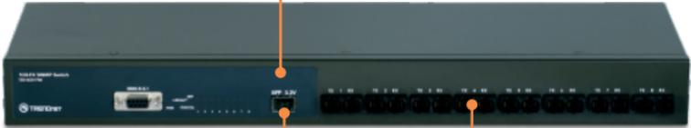
3. Verbinden Sie einen der Anschlüsse des Umschalters über ein Glasfaserkabel mit einem Glasfaseranschluss Ihres Netzwerks.
