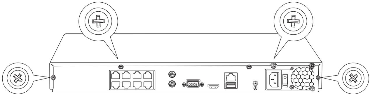
2. Schieben Sie die Abdeckung vom Gerät ab, indem Sie die Abdeckplatte zur Rückplatte hin ziehen.
