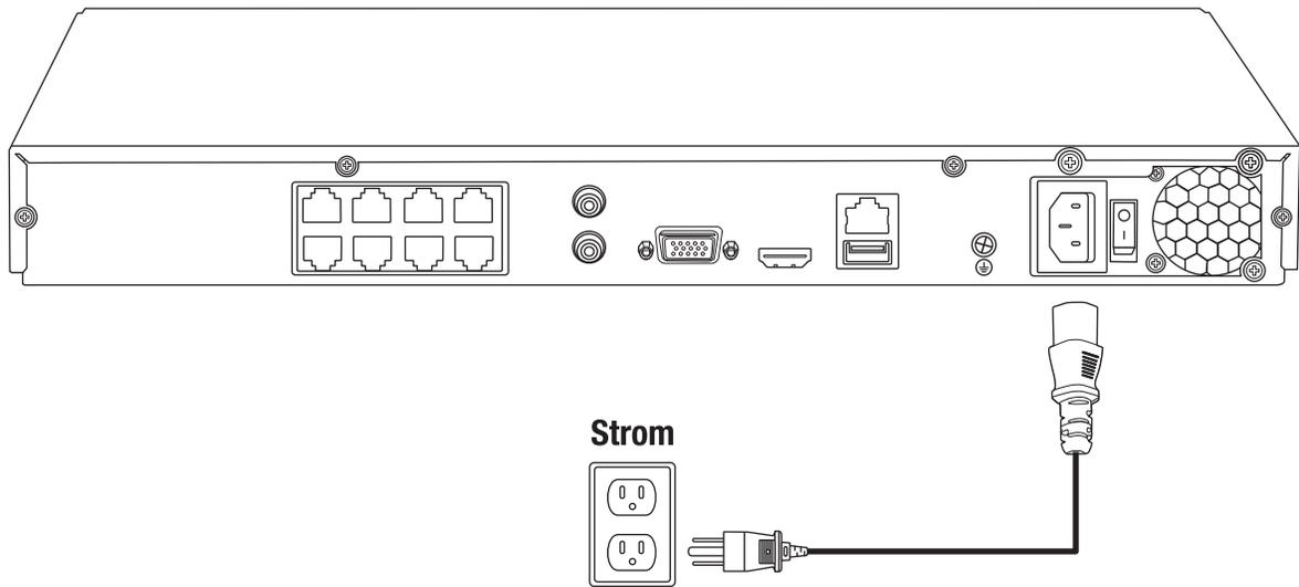
4. Schalten Sie den Netzschalter auf der Rückseite in die **On** Position.
