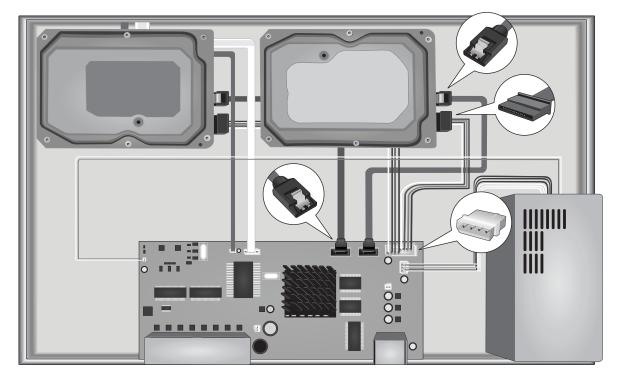
**4.** Fixez le disque dur à la baies du TV-NVR208 en utilisant les 4 vis de fixation, en vissant la partie inférieure du TV-NVR208 au boîtier du disque dur.
