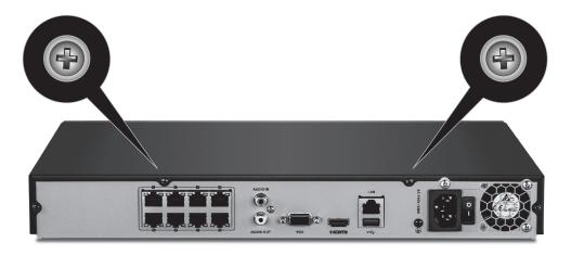
2. Faites glisser le couvercle de l'appareil en tirant le couvercle vers le panneau supérieur.
