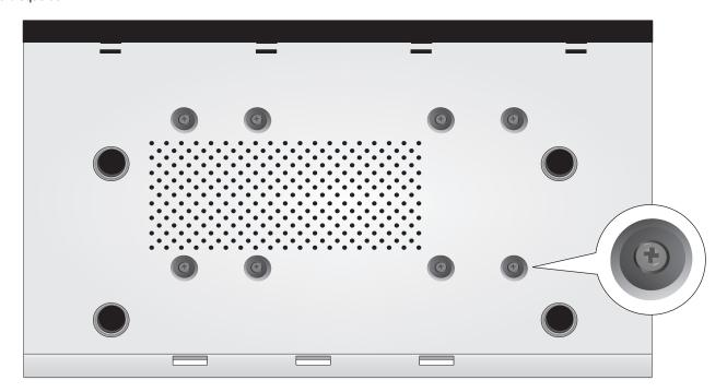
5. Faites glisser le couvercle du TV-NVR208 afin de le remettre en place et remettez les vis maintenant le panneau.
