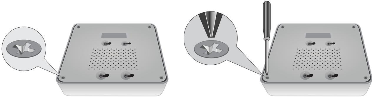
2. Die obere Abdeckung enthält vertikale Schlitzte. Schieben Sie die Abdeckung von der Rückseite des Geräts vorsichtig hoch, um sie von der Bodenplatte zu trennen.
