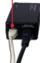
3. Conecte um cabo CAT-5e/6 do TV-IP612P à porta DATA OUT do TPE-111GI.
