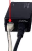
3. Verbinden Sie den DATA OUT-Port des TPE-111GI über ein Kat.5e/6-Kabel mit dem TVIP612P.
