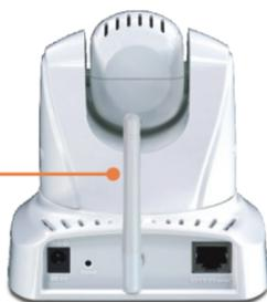
8. Verbinden Sie den Ethernet-Port der IP-Kamera über ein RJ-45-Netzwerkkabel mit einem Switch/Router.
