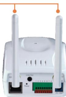
8. Branchez un câble réseau RJ-45 entre le Switch/Routeur et le port Ethernet de la caméra IP.
