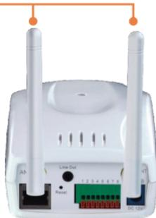
8. Verbinden Sie den Ethernet-Port der IP-Kamera über ein RJ-45-Netzwerkkabel mit einem Switch/Router.
