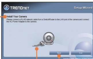
8. Branchez le transformateur AC au caméra IP et ensuite à une prise de courant.
