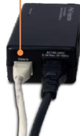
3. Conecte un cable CAT-5e/6 del TV-IP501P al puerto DATA OUT del TPE-111GI.
