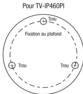
2. Forez des trous à chaque emplacement indiqué sur le modèle. Assurez-vous que la mèche de la foreuse corresponde à la taille des trous du modèle.
