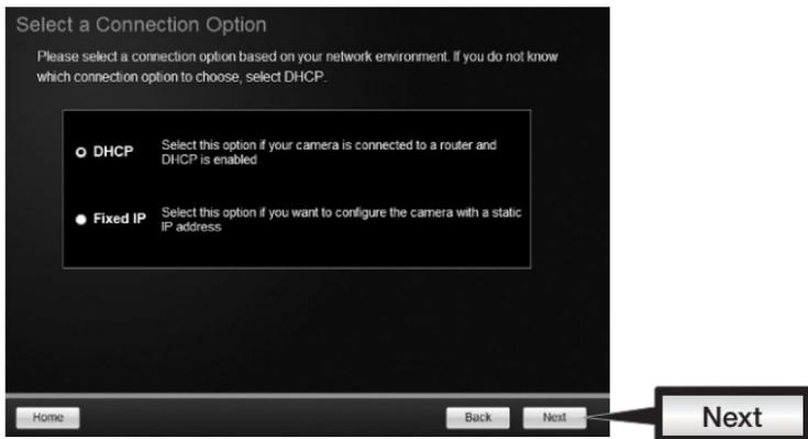
9. Se viene selezionato "IP Fisso", compilare il campo dell'indirizzo IP, subnet mask, gateway predefinito e server DNS. Accertarsi che l'indirizzo IP della telecamera e del computer si trovino all'interno della medesima rete. Cliccare su **Next (Avanti)**.
