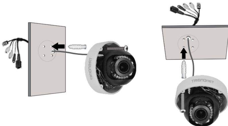
7. Posizionare manualmente la telecamera come desiderato e fissare saldamente l'alloggiamento.
