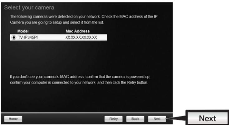
8. Selezionare DHCP per assegnare un IP mediante server DHCP del "IP fisso" selezionato per impostare l'indirizzo IP manualmente. Cliccare su **Next (Avanti)**.
