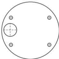
3. Haga orificios en cada posición marcada en la plantilla. Asegúrese de que el tamaño del taladro corresponda al tamaño de los orificios de la plantilla.
