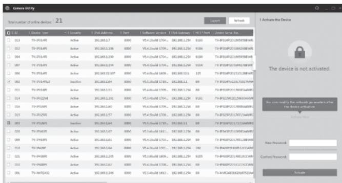
5. Lorsque l'appareil est activé, double-cliquez sur l'adresse IP pour ouvrir l'interface de gestion dans le navigateur Internet.
