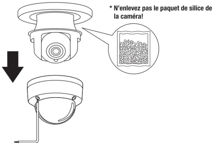
4. Insérez les chevilles dans les trous et alignez la base de fixation sur ces derniers. Utilisez ensuite les vis fournies pour fixer la caméra sur la surface de fixation.
