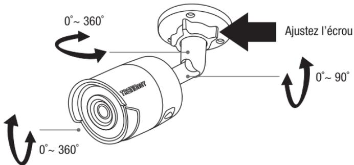
4B. Dôme: Ajustez manuellement votre caméra dans l'angle de visualisation désiré. Lorsque vous avez terminé, remettez le couvercle du dôme en place en utilisant la clé Allen de sécurité Torx.
