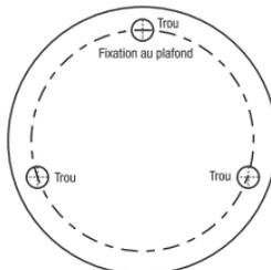
2. Forez des trous à chaque emplacement indiqué sur le modèle. Assurez-vous que la mèche de la foreuse corresponde à la taille des trous du modèle.
