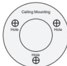
3. Bohren Sie die Löcher für die beigelegten Dübel an den in der Schablone markierten Stellen. Stellen Sie sicher, dass der Bohreinsatz der Größe der beigelegten Dübel angemessen ist.
