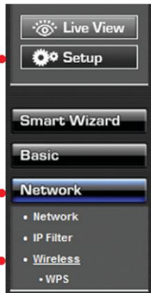
13. Нажмите "Обзор сайта". Выберите ESSID. ESSID-это имя беспроводной сети для вашей беспроводной сети (напр., беспроводной маршрутизатор или точка доступа). Если используется шифрование, выберите соответствующий тип авторизации и шифрования, введите общий ключ и нажмите "Применить". (В данном примере показано шифрование WPA2-PSK. Если беспроводная сеть не поддерживает WPA, выберите опцию открытого или совместного использования. За более подробными сведениями обращайтесь к администратору сети).
