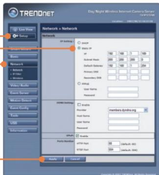
**6. Выберите Сеть и далее Беспроводное соединение. Задайте настройки беспроводного соединения, которые должны соответствовать вашим настройкам беспроводного соединения и нажмите на Применить (включите/введите ключ WEP/WPA, если беспроводная сеть шифруется). Обратитесь к сетевому администратору, который сообщит подробности).**
