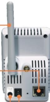
2. Verbinden Sie den **Ethernet-Port** der Internetkamera über ein RJ-45 Netzwerkkabel mit einem Switch/Router.
