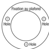
3. Forez des trous à chaque emplacement indiqué sur le modèle. Assurez-vous que la mèche de la foreuse corresponde à la taille des trous du modèle.
