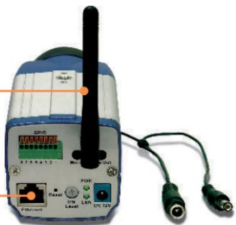
3. Branchez un câble réseau RJ-45 depuis un Switch/Routeur vers le port **Ethernet** de la Webcam.
