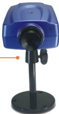
2. Присоедините сетевой кабель RJ-45 от коммутатора/маршрутизатора к порту LAN Интернет-камеры.
