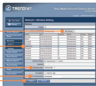
Hinweis: Der TV-IP121W funktioniert nur dann drahtlos, wenn Sie das Ethernet-Kabel von der Kamera getrennt haben.
