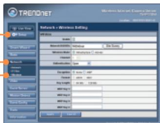
13. Щелкните по кнопке **Ste Survey**. Выберите беспроводную сеть. Если включено шифрование, выберите нужный тип **Аутентификации**, укажите Общий ключ и нажмите на кнопку Применить. (На примере WPA2-PSK. Если беспр. сеть не поддерживает WPA, выберите вариант «открытый» или «общий». Обратитесь к сетевому администратору, который сообщит подробности) (Только TV-IP110W).
