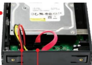
3. Befestigen Sie die Festplatte mit den beiliegenden Schrauben am TU3-S35.
