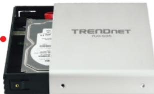
2. Verbinden Sie SATADatenkabel und - Stromanschluss mit der SATA-Festplatte.
