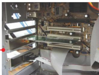
10. Плотно задвиньте PCIe-карту в свободное гнездо для PCIe, затем включите компьютер. Дождитесь полной загрузки Windows.
