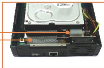
4. Вставьте жесткий диск в металлический держатель и закрепите его 4-мя крепежными винтами.
