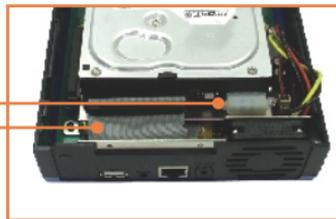
4. Setzen Sie die Festplatte in die Metallklammer ein und befestigen Sie sie mit 4 Schrauben.
