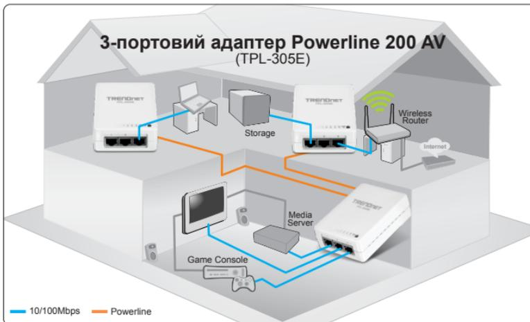
На прикладі схеми показана типова конфігурація мережі Powerline в домашньому середовищі з 3 адаптерами Powerline, встановленими в різних кімнатах. Оранжева лінія показує підключення, встановлене через електричну систему вашого будинку, а сині лінії показують підключення Ethernet категорії 5, 5e, 6 до приладів, що підтримують мережеве з'єднання, таких як комп'ютер, маршрутизатор або IP-телеприставка, підключена до вашого телевізора.
