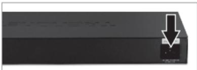
2. Conecte un cable de red RJ-45 del PC a un puerto Ethernet disponible en el TPE-224WS.
