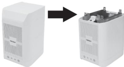
3. Insérez le(s) disque(s) dur(s) SATA et enfoncez-le(les) jusqu'à ce que le disque dur soit solidement fixé au connecteur SATA.
