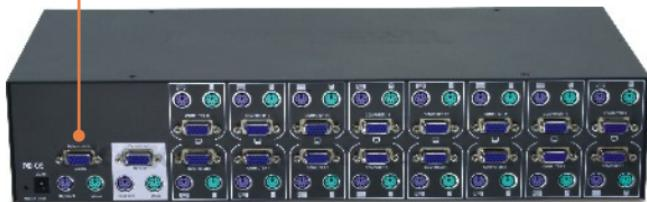
7. Conecta el otro extremo del cable de conexión en serie al **puerto consola** del segundo conmutador (esclavo).
