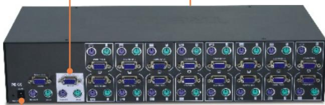
4. Alimente el conmutador KVM conectando el adaptador AC incluido a un tomacorriente.
