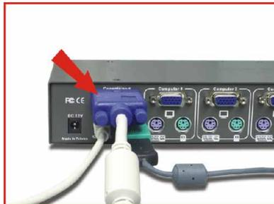
3. Verbinden Sie die integrierten KVM-Anschlusskabel mit den jeweiligen Anschlüssen der Computer für Video, PS/2-Tastatur und PS/2-Maus.
