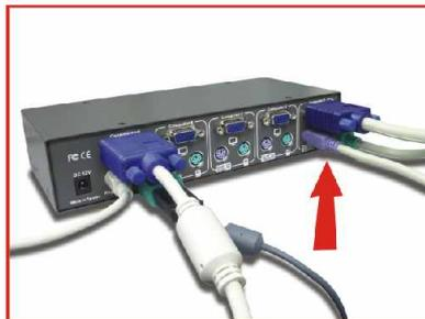
4. Schalten Sie beide Computer ein. Sobald die Computer vollständig hochgefahren sind, können Sie den KVM-Umschalter benutzen. **Die Installation ist jetzt abgeschlossen.**
