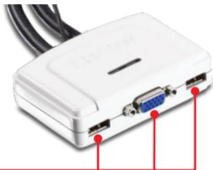
3. Verbinden Sie beide Computer über die integrierten KVM-Kabel mit dem KVM-Umschalter.
