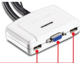
3. Utilisez les câbles KVM intégrés pour brancher vos deux ordinateurs au Switch KVM.
