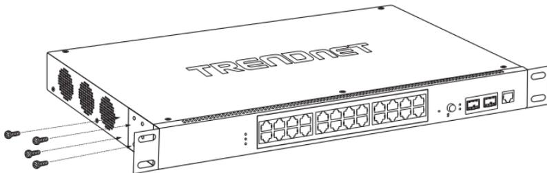
Utilice los tornillos del bastidor del equipo para montar cada switch en el bastidor.
