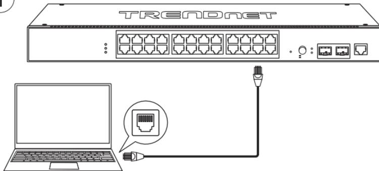
2. Assegnare un indirizzo IP statico all'adattatore di rete del vostro computer nella subnet di 192.168.10.x (e.g. 192.168.10.25) e una subnet mask di 255.255.255.0.
