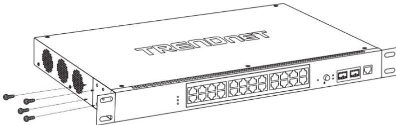
Utilizzare le viti in dotazione per installare ogni switch nel rack.
