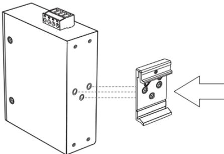
2. Installez l'appareil en face du rail DIN et accrochez le support de fixation au-dessus du rail.
