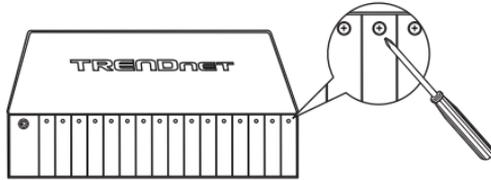
2. Lösen Sie die Schraube und nehmen Sie den Glasfaserkonverter aus dem Metallgehäuse.
